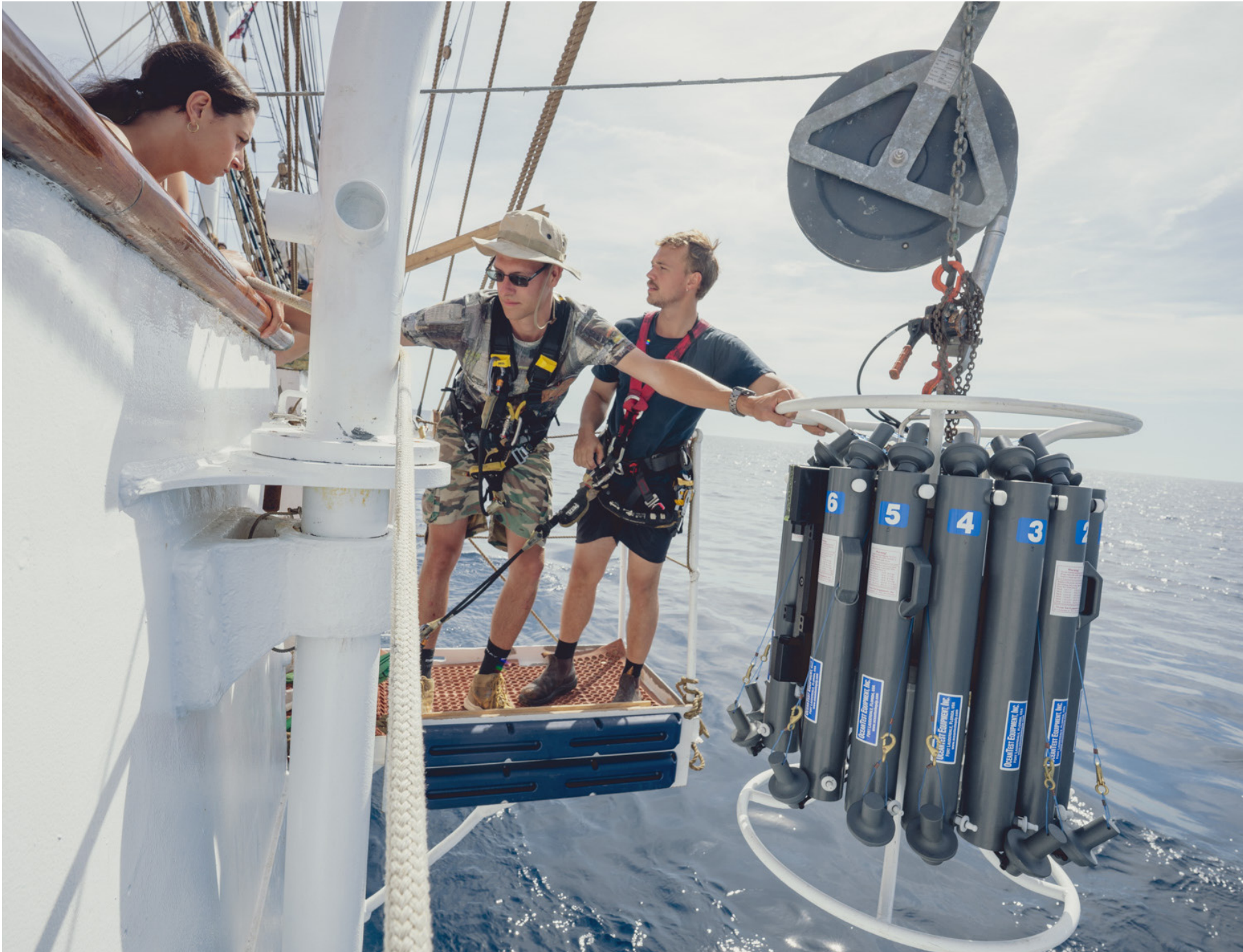
CTD-en klargjøres for innsamling av vannprøver. Instrumentet måler temperatur, saltholdighet og dybde i vannmassene og gir viktig kunnskap om havets tilstand. Foto: Matteo Baratella
